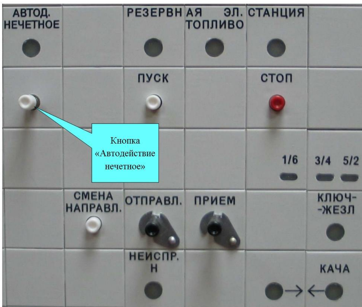
Рис. 25. Фрагмент пульт-табло со сменой направления
